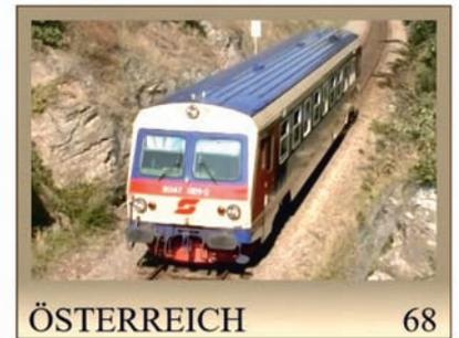
Von den ÖBB wurden 1983 ein Auftrag für sechs neue Dieseltriebwagen, nach dem Vorbild der deutschen Baureihe 627, an die Jenbacher Werke vergeben. Das erste Fahrzeug der Baureihe VT5047 wurde 1987 ausgeliefert und bei einer internationalen Pressefahrt vorgestellt. Diese Fahrt führte am 10.08.1987 mit dem VT 5047.001, von Wien über Sigmundsherberg und Horn, durch das Kamptal nach Rosenburg und wieder zurück nach Wien.
